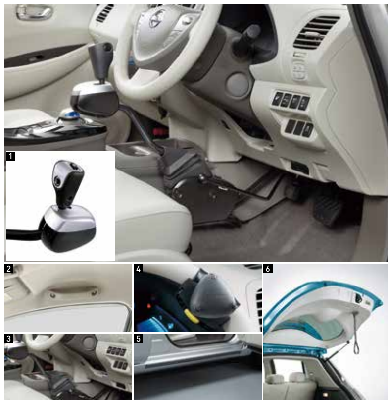
1 コントロールグリップ 2 運転席マイティグリップ (100Kg 耐荷重) 3 手押し式パーキングブレーキ 4 ステアリングノブ 5 サイドシルガード 6 バックドアストラップは標準装備です。手動運転装置のみの販売はございません。
